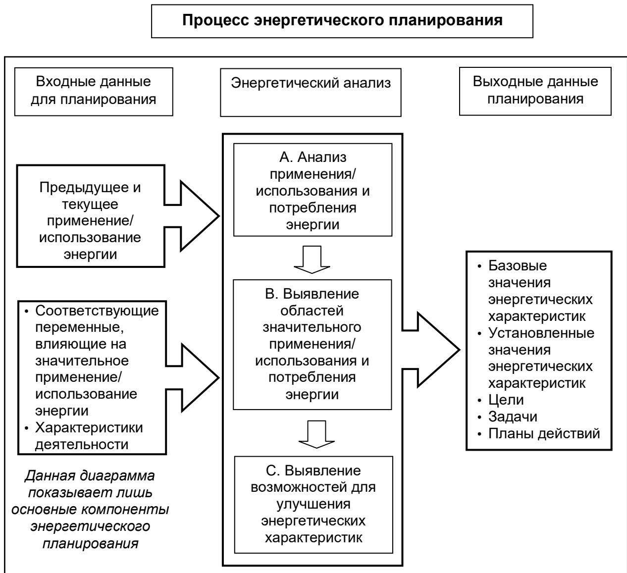
Рис. А.2. Концептуальная схема процесса энергетического планирования
